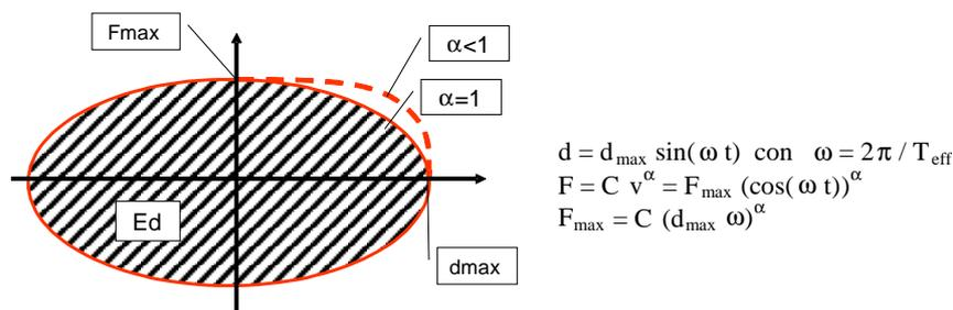
**Figura 11.9.2** – Dispositivi a comportamento viscoso
