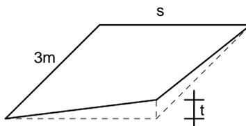
Figura 5.2.14 - Sghembo ammissibile
